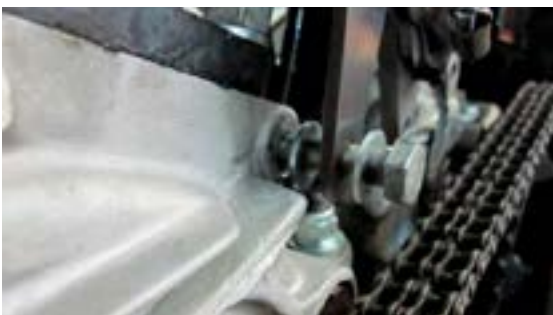
Unterlegscheiben nach Bedarf platzieren für einen spannungsfreien Anbau
