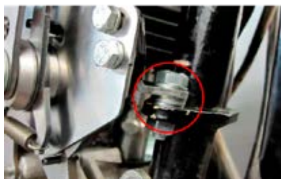
Installation sans câble d'embrayage d'origine
