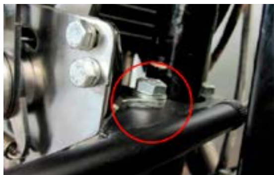
Posizione dell'angolo di fissaggio posteriore
