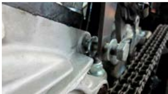
Piazzare rondelle secondo necessità per un'installazione priva di tensione
