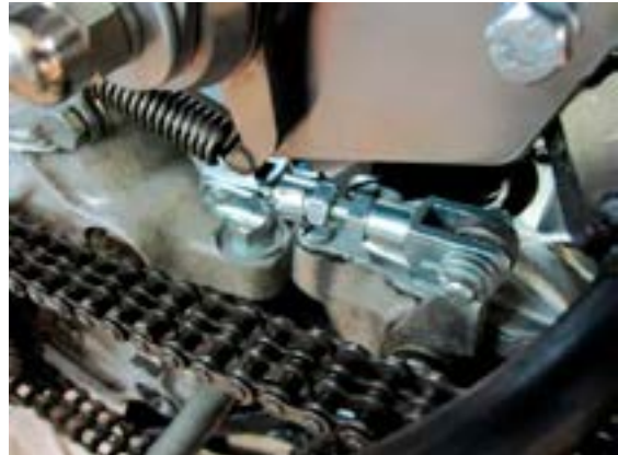
Conexiones de cambio con horquilla
