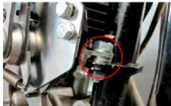
Colocación del soporte en ángulo trasero de la carraca del cambio
