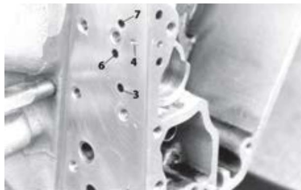
(3) lubricación la cadena primaria (4) lubricación del cigüeñal, (6) lubricación de los empujadores y culatas, (7) pasaje de sobrepresión
