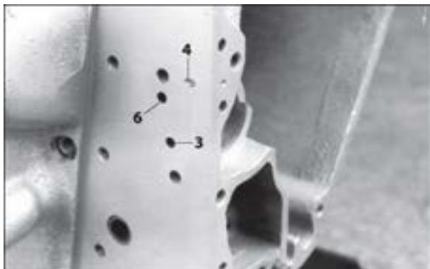
(3) lubrification de la chaîne primaire, (4) lubrification du vilebrequin, (6) lubrification des poussoirs et des culasses.
