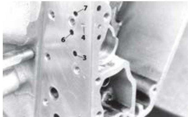
(3) lubrification de la chaîne primaire, (4) lubrification du vilebrequin, (6) lubrification des poussoirs et des culasses, (7) passage de décharge de surpression
