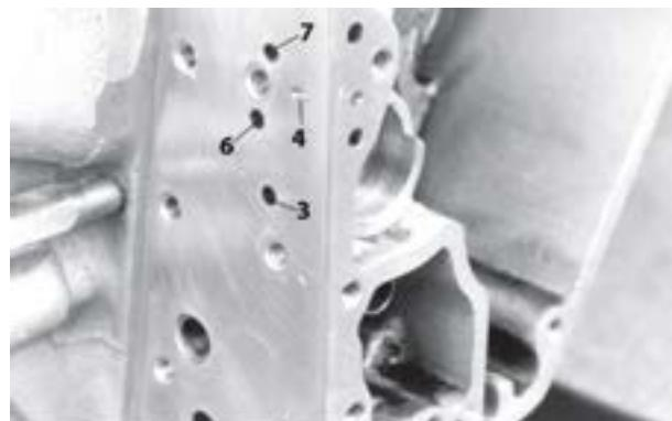
(3) lubrificazione della catena primaria (4) lubrificazione dell'albero motore, (6) lubrificazione delle punterie e delle teste dei cilindri, (7) passaggio di sovrapressione
