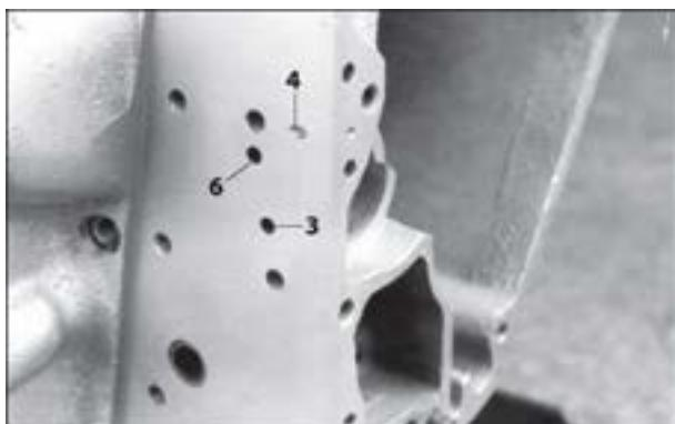
(3) lubrificazione della catena primaria (4) lubrificazione dell'albero motore, (6) lubrificazione delle punterie e delle teste dei cilindri
