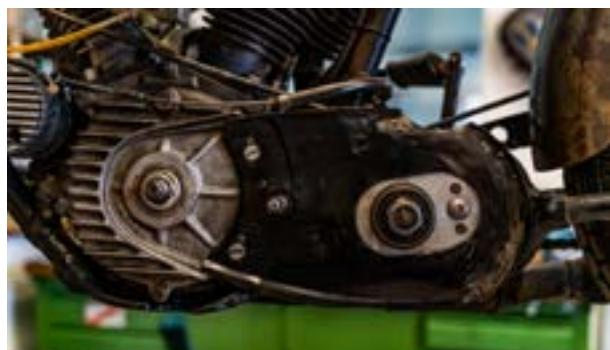
Desserrez légèrement la boîte de vitesses à l'avance, afin de tendre correctement la courroie par la suite.
