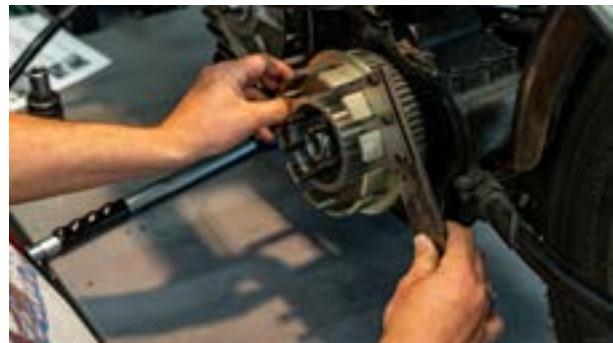
Serrez maintenant l'écrou du moyeu d'embrayage à un couple de 150 Nm.
