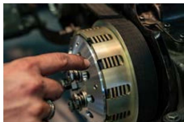
Montate ora anche il coperchio primario e controllate infine che l'azionamento primario scorra liberamente.
