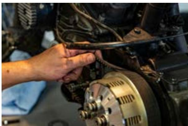
Vuelva a comprobar la tensión de la correa después de apretar las 3 tuercas del engranaje.
