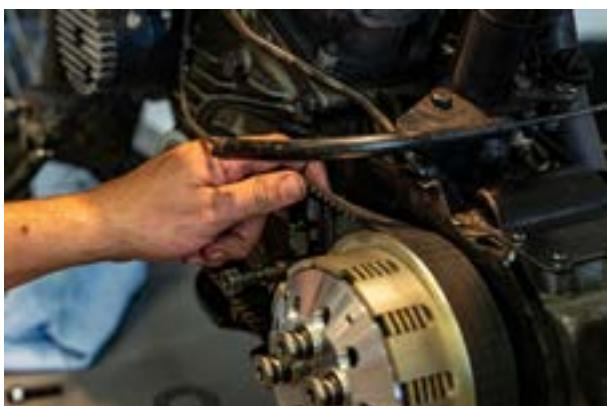
Ricontrollare la tensione della cinghia dopo aver stretto i 3 dadi della trasmissione.
