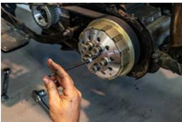
Lors du débrayage, le plateau de pression doit être dans la position maximale indiquée (plateau de pression sortant juste du panier d'embrayage). Si la course de débrayage est trop importante, il faut donner plus de jeu ou appliquer une butée, par exemple à la pédale d'embrayage.
