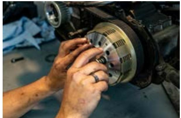
Die innerste Scheibe ist eine Reibscheibe, die äußerste eine Stahlscheibe (s. Bild).
