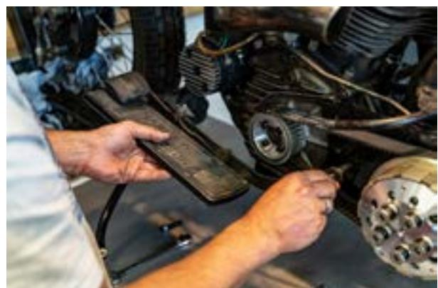
Ponga la bola endurecida en el tornillo de ajuste de la varilla de presión con un poco de grasa, ajuste el embrague con algo de juego y apriete la contratuerca.
