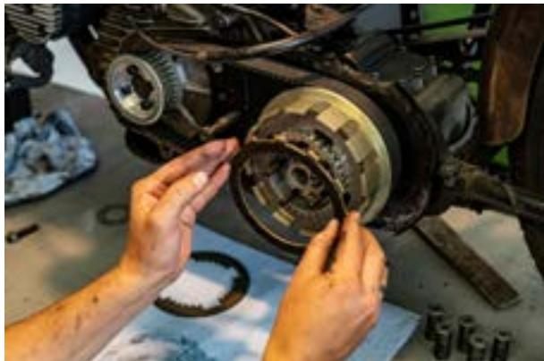
Setzen Sie die Druckplatte auf und montieren Sie die jeweils 5 Federhülsen, Federn und Spannmuttern.
