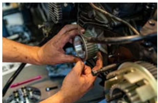
Mettez la courroie en place et montez la poulie sur l'adaptateur avec le nombre déterminé d'entretoises. Pour l'instant, ne serrez que légèrement les 4 vis BTR, le serrage final avec un couple de 20 Nm et un frein-filet de force moyenne peut être effectué plus tard avec la roue arrière bloquée.
