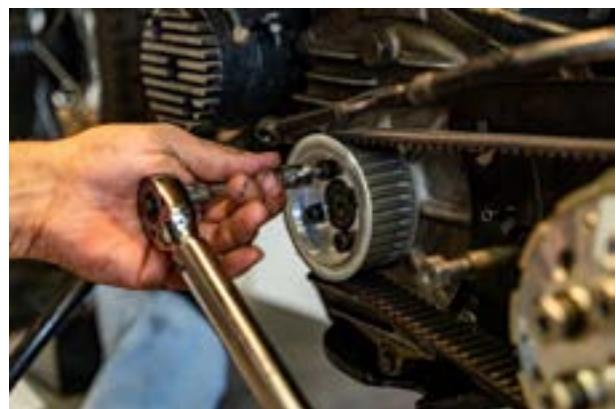
Assemblez provisoirement tous les éléments d'actionnement de l'embrayage sans le cache primaire.
