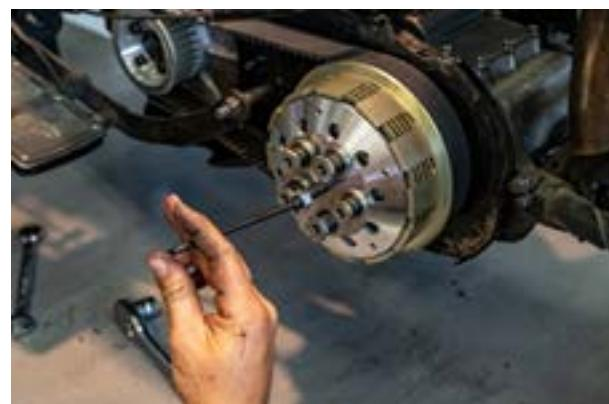
Lo spigidisco dovrebbe essere nella posizione massima indicata (spigidisco che lascia appena la campana della frizione) quando si disinnesta. Se la corsa di disinnesto è troppo lunga, date più gioco o montate un arresto, per esempio sul pedale della frizione.
