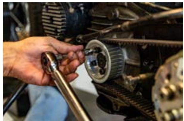
Montieren Sie temporär sämtliche Kupplungsbetätigungsselemente ohne den Primärdeckel.
