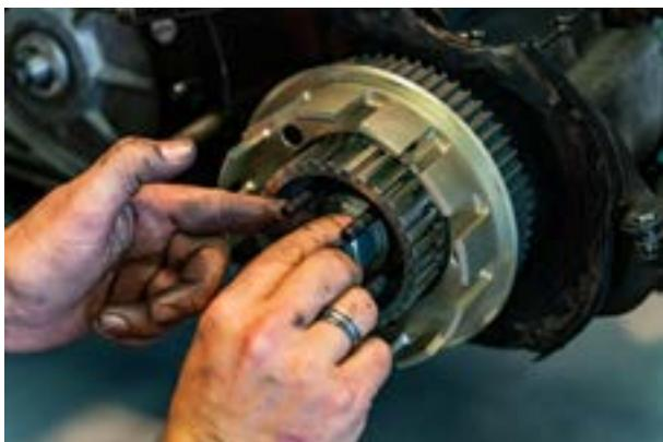
Prüfen Sie, ob sich der Kupplungskorb frei dreht und mindestens 1mm umlaufend Freigang zur inneren Primärabdeckung aufweist.
