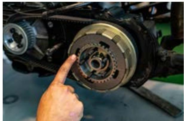
Montare i dischi in acciaio in modo che i 4 ritagli di ventilazione nel disco siano sempre uno sopra l'altro, formando un canale d'aria.
