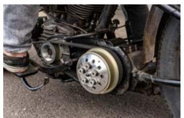
Die Druckplatte sollte beim Ausrücken maximal die gezeigte Stellung einnehmen (Druckplatte verlässt gerade den Kupplungskorb). Bei zu weitem Ausrückweg mehr Spiel geben oder Anschlag z.B. an Kupplungswippe anbringen.
