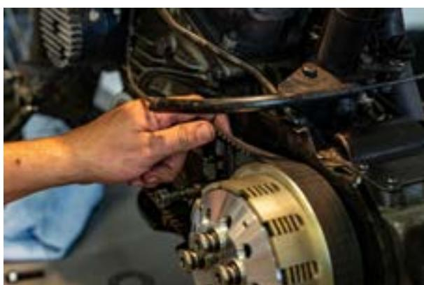
Contrôlez à nouveau la tension de la courroie après avoir serré les 3 écrous de transmission.
