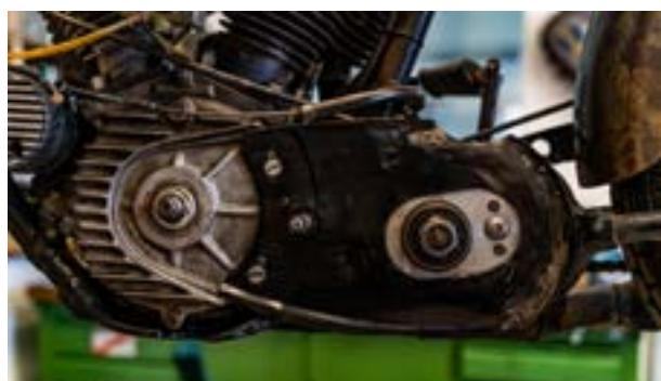
Pulire l'albero primario della trasmissione e il perno dell'albero motore, e disattivare il sistema primario di lubrificazione della catena.
