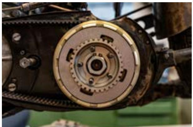
Montez alternativement les 5 disques de friction et les 5 disques en acier.
