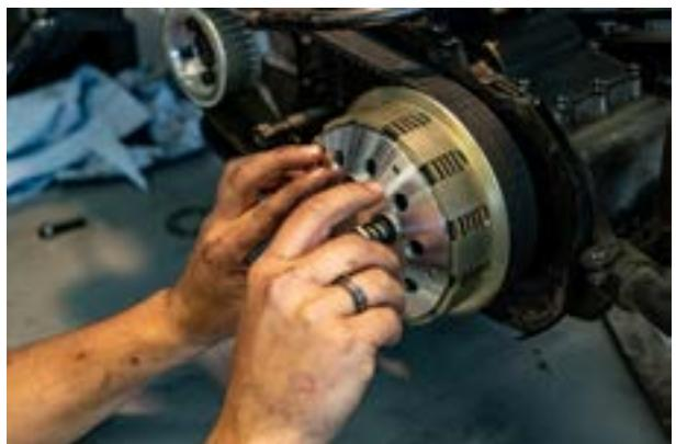
Le disque le plus intérieur est un disque de friction, le plus extérieur un disque en acier (voir photo).
