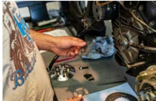
Sollte die Passfeder zu hoch sein und in der Nut des Adapters anliegen, muss die Passfeder entsprechend bearbeitet werden.
