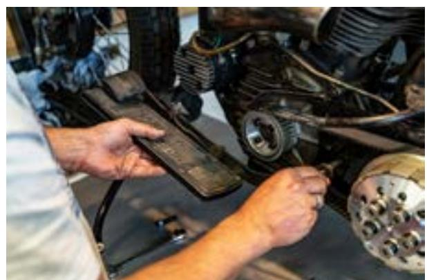
Überprüfen Sie die Riemenspannung nach dem Anziehen der 3 Getriebemuttern nochmals.
