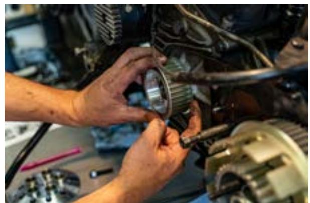
Coloque la correa y monte la polea en el adaptador junto con el número determinado de espaciadores. Apretar los 4 tornillos hexagonales sólo ligeramente por el momento, el apriete final con un par de 20 Nm y fijador de roscas se puede hacer más tarde con la rueda trasera bloqueada.
