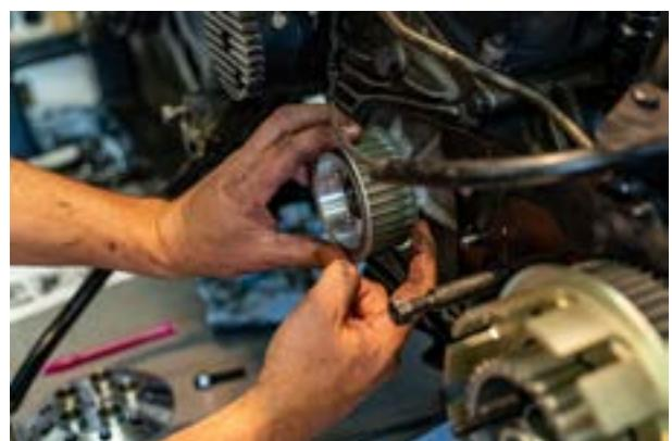
Posizionare la cinghia e montare la puleggia insieme al numero determinato di distanziatori sull'adattatore. Stringere le 4 viti a brugola solo leggermente per il momento, il serraggio finale con 20 Nm di coppia e frenafiletto a media resistenza può essere effettuato più tardi con la ruota posteriore frenata.
