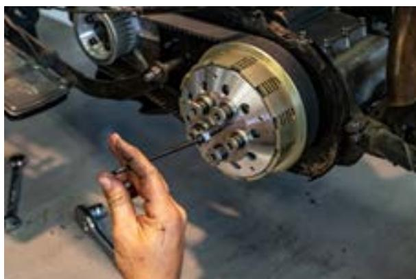
Al desembragar, el disco de presión debe estar en la posición máxima indicada (disco de presión justo saliendo de la campana de embrague). Si el recorrido de desembrague es excesivo, dé más juego o aplique un tope, por ejemplo, al pedal del embrague.
