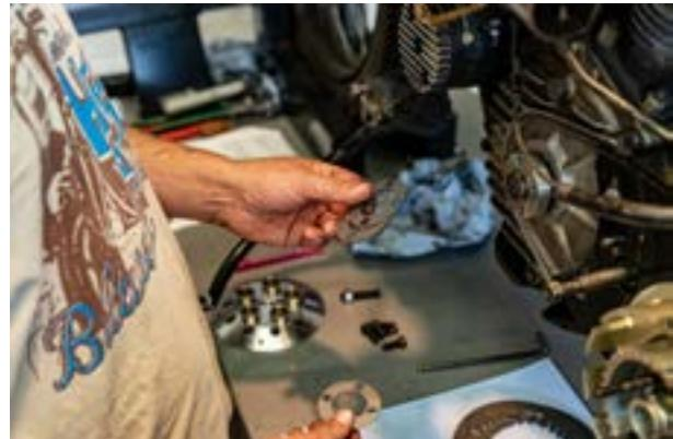
Si la clavette est trop haute et touche le fond de la rainure de l'adaptateur, elle doit être usinée en conséquence. Serrez maintenant l'écrou du vilebrequin à 100 Nm. La poulie de la courroie du moteur doit être axialement aussi proche que possible du carter du moteur.
