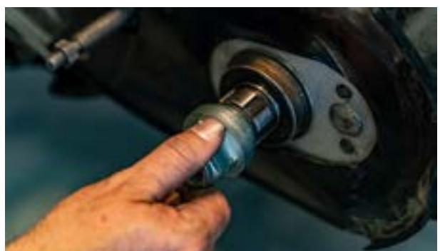
Posizionare il gruppo frizione sull'albero della trasmissione, oliare le filettature e il collare del dado (diametro grande), e serrare leggermente il dado.
