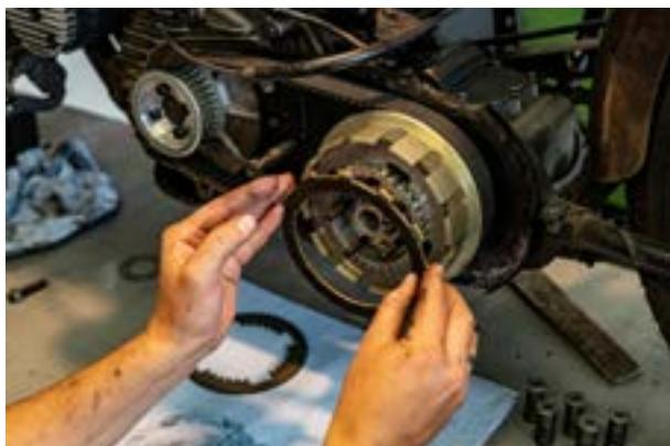
Posez le plateau de pression et montez chacun des 5 douilles à ressort, ressorts et écrous de réglage.
