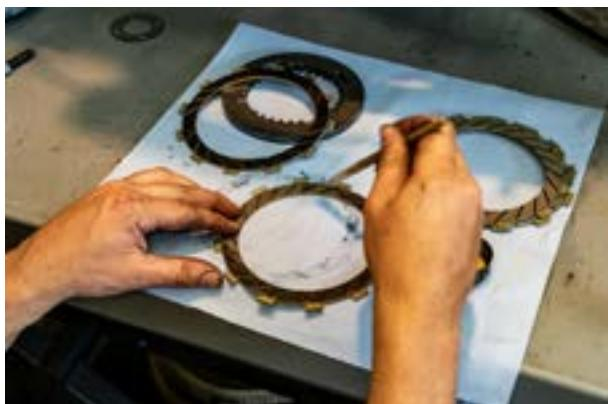
Monter les disques en acier de manière à ce que les 4 ouvertures de ventilation du disque soient alignées les unes par rapport aux autres et forment un canal d'air.
