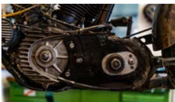
Reinigen Sie die Getriebe eingangswelle und den Kurbelwellenzapfen und legen Sie die Primärkettenbeölzung still.
