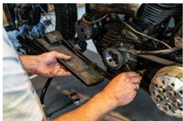
Mettez la bille trempée dans la vis de réglage de la tige de pression avec un peu de graisse, réglez l'embrayage avec un peu de jeu et serrez le contre-écrou.
