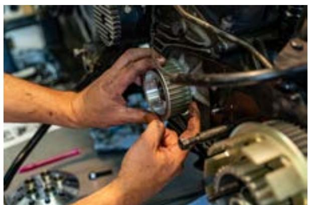
Legen Sie den Zahnriemen auf und montieren Sie das Riemenrad zusammen mit der ermittelten Anzahl der Distanzscheiben auf den Adapter. Die 4 Innensechskantschrauben vorerst nur leicht anziehen, der Endanzug mit 20 Nm Drehmoment und mittelfester Schraubensicherung kann später mit gebremstem Hinterrad erfolgen.
