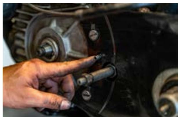
Getriebe vorab schon einmal leicht lösen, um später den Riemen korrekt spannen zu können.
