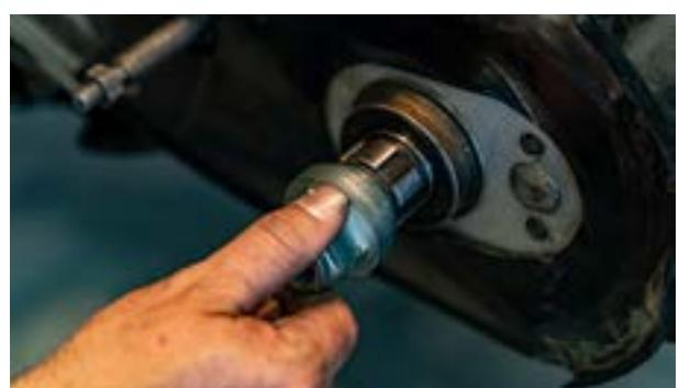
Setzen Sie die Kupplungsbaugruppe auf die Getriebeeingangswelle, ölen Sie das Gewinde und den Auflagebund der Mutter (großer Durchmesser) und ziehen Sie die Mutter leicht an.
