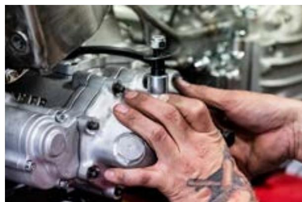
Posizionare prima la rondella di spinta (utilizzare quella esistente) e poi il distanziale dell'albero del kicker con la vite senza testa e la scanalatura sull'albero del kicker. Serrare la vite a 12 Nm.
