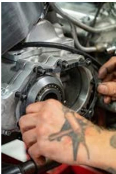
est orienté vers vous, placer la rondelle de blocage et serrer l'écrou (68 Nm).
