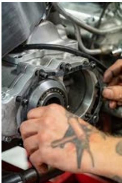
zeigt, wenn die Stellschraubenbohrung in der Welle zu Ihnen zeigt, das Sicherungsblech anbringen und die Mutter anziehen (68 Nm).
