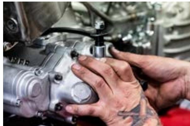
Coloque primero la arandela de tope (utilice la existente) y luego el espaciador con el tornillo de fijación y la ranura en el eje. Apriete el tornillo de fijación a 12 Nm.
