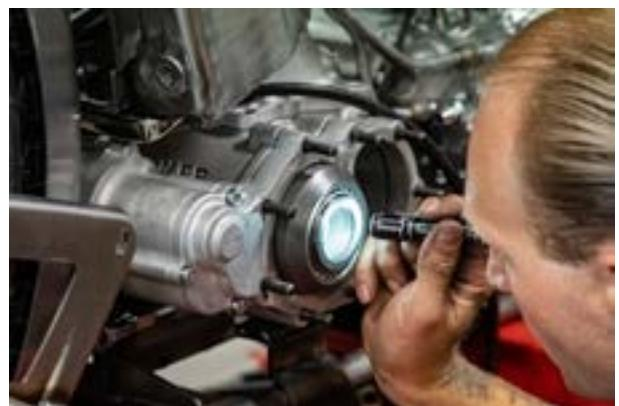
Sicherungsblech auf die Hauptwelle stecken und Hauptwellenmutter festziehen (50 ft-lbs), Sicherungsblech mit Schraubendreher an eine Sechskantfläche der Mutter drücken.
