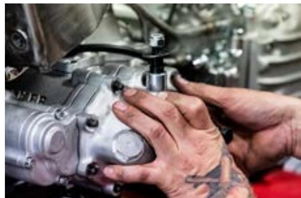
Zuerst die Druckscheibe (vorhandene Scheibe verwenden) und dann das Distanzstück für die Kickerswelle mit Stellschraube und Schlitz auf die Kickerswelle setzen. Ziehen Sie die Stellschraube mit 12 Nm an.
