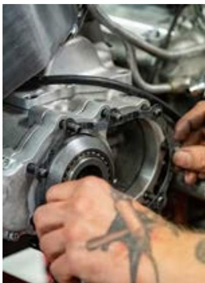
Montare il pignone di avviamento sull'albero del kicker esteso in modo che il perno del pignone sia rivolto verso sinistra, quando il foro della vite senza testa nell'albero è rivolto verso di voi, posizionare la rondella di bloccaggio e serrare il dado (68 Nm).
