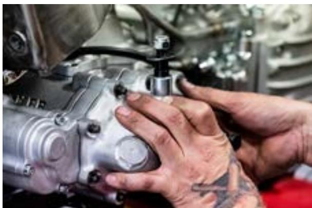
Placer d'abord la rondelle de butée (utiliser celle qui existe déjà), puis l'entretoise de l'arbre avec la vis de blocage et la fente sur l'arbre de renvoi. Serrer la vis de blocage à 12 Nm.
