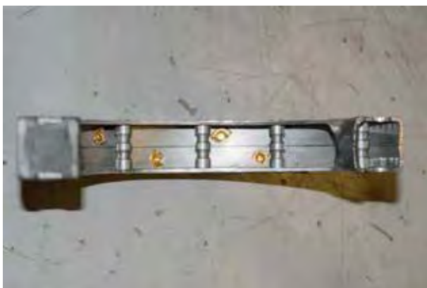
El resultado de remachar sin la buena herramienta...
