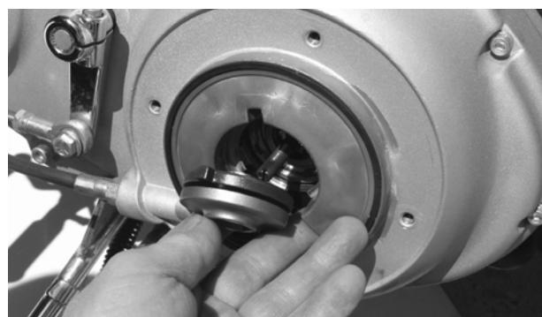
8. Insérer l'écrou de sécurité de l'embrayage avec le ressort et refermer le carter.
