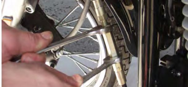
3. Déposer la trappe de service avec l'outillage adapté, retirer l'écrou de blocage avec le ressort ensuite serrer la vis de réglage dans le sens des aiguilles d'une montre avec un tournevis plat, afin de pouvoir détacher l'écrou spécial du segment d'embrayage.
