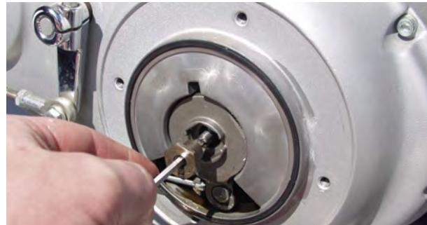
5. Conecte el cable del embrague al segmento Müller nuevo e instale éste en la cubierta lateral.
