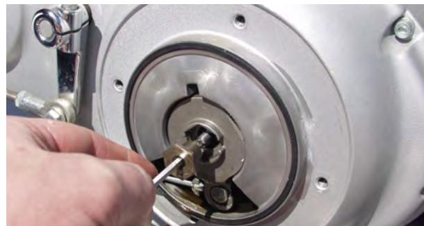
4. Staccare il segmento frizione dal cavo, togliere il segmento e trasferire le tre sfere nel segmento Müller.
