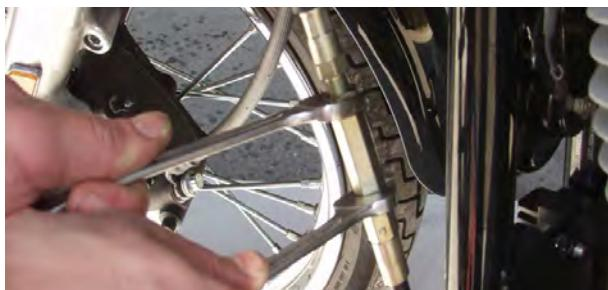
3. Servicedeckel für Kupplungseinstellung mit geeignetem Werkzeug lösen, Sicherungsmutter mit Feder entfernen, anschließend mit Schlitz-Schraubendreher im Uhrzeigersinn die Einstellschraube nach innen drehen, damit sich die Spezialmutter vom Kupplungssegment trennen lässt.
