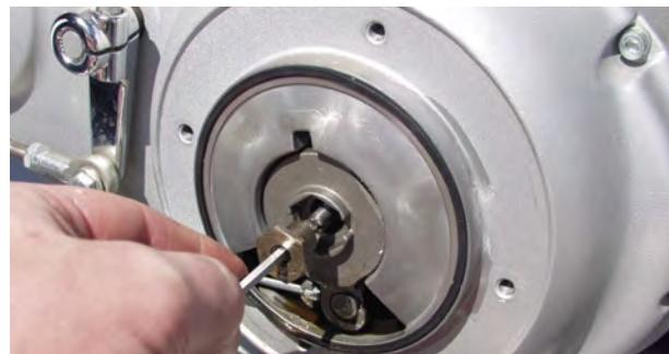
4. Détacher le segment d'embrayage du câble, déposer le segment et insérer les trois billes dans le segment Müller.
