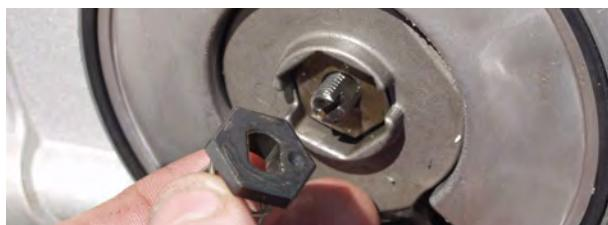
4. Desconecte el cable del segmento del embrague, extraiga el segmento y coloque las tres bolas en el segmento Müller.
