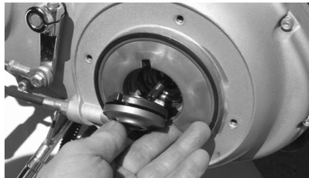
7. Ajuste el embrague de acuerdo con el manual del fabricante. Gire el tornillo de ajuste todo lo que pueda en sentido antihorario hasta el punto de resistencia y tire de la maneta del embrague varias veces. Repita este proceso unas cuantas veces para que no haya juego y, a continuación, apriete el tornillo de ajuste 1/8 de vuelta más para que quede seguro.
