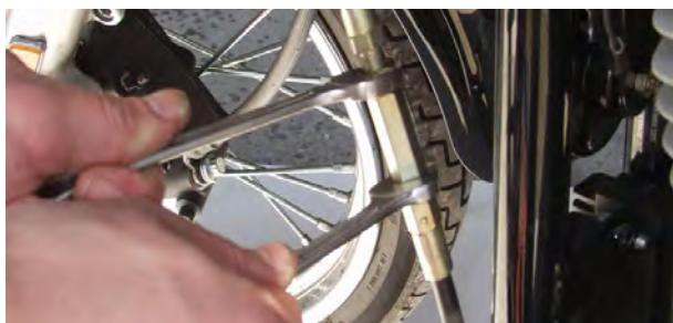
3. Extraiga la cubierta de servicio de ajuste del embrague con una herramienta adecuada, retire la tuerca autoblocante con muelle y, a continuación, use un destornillador y gire el tornillo de ajuste en sentido horario hasta que la tuerca especial se despegue del segmento del embrague.
