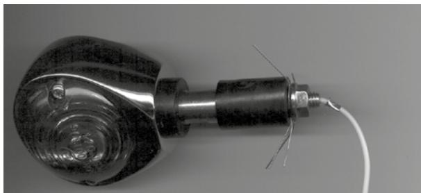
Saque los cables por el manillar y presione el intermitente en su sitio. Rosca la unidad hasta que quede firme y los cables de masa hagan buen contacto en el interior del manillar. De los manillares cubiertos en epoxy o pintados tiene que quitar la pintura por lo menos tanto que se haga buen contacto a la masa.
