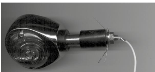
Poi si fa passare il cavo nel manubrio e si inserisce la freccia nel manubrio fino alla battuta. La freccia si fissa girando in senso orario. In questo modo il manicotto di gomma si tende e i cavi di massa vengono premuti correttamente contro la parete interna del manubrio. Sui manubri verniciati o rivestiti in polvere si ha da rimuovere il rivestimento per fare buon contatto alla massa.
