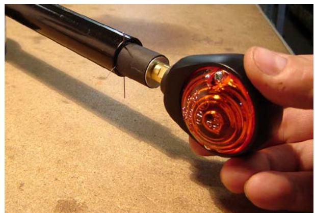
La freccia va stretta tanto da farla stare ben salda e da disporre parallelamente all'asse di lunghezza della moto le due lenti di diffusione.
