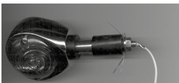
Dann wird das Kabel durch den Lenker gezogen und der Blinker in den Lenker bis zum Anschlag eingeschoben. Der Blinker wird durch Drehen im Uhrzeigersinn befestigt. Dadurch wird die Gummimuffe gespannt und die Massedrähte werden korrekt an die Lenkerinnenwand gedrückt. Lackierte oder beschichtete Lenker müssen auf der Innenseite wenigstens soweit blank sein, dass ein guter Massekontakt hergestellt werden kann.
