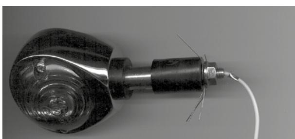
On tire ensuite le câble à travers le guidon et on pousse le clignotant jusqu'au bout. Le clignotant est fixé en le tournant dans le sens des aiguilles d'une montre. Ce qui a pour effet de tendre le manchon en caoutchouc et presse les fils de masse contre la paroi interne du guidon. Des guidons peints ou à finition époxy, il faut enlever autant de la couverture de l'intérieur pour faire un bon contact à la masse.
