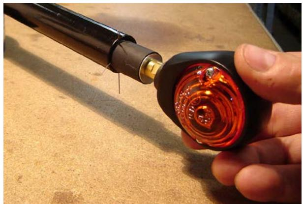
El intermitente ha de quedar fijo, de manera que no pueda girarse o vibrar libre, y las dos lentes han de quedar en sentido vertical y paralelos al eje longitudinal de la moto.
