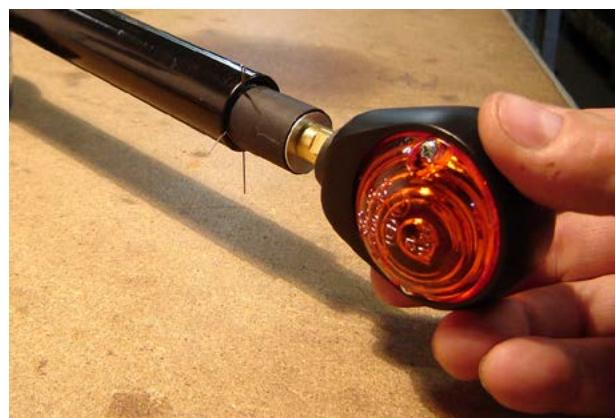
Le clignotant est serré jusqu'à être installé fermement et que les deux optiques soient dirigés de façon parallèle à l'axe longitudinal de la moto.
