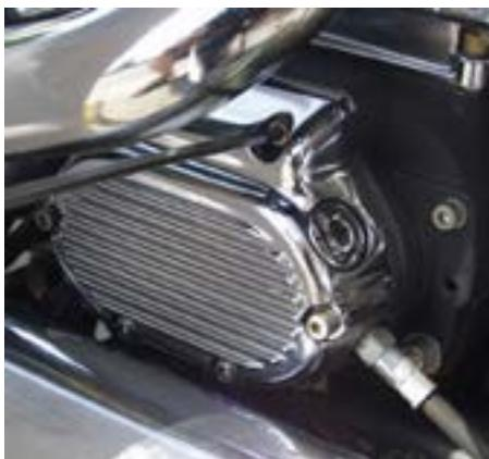
11. Ajusta el cable de embrague para dejar un juego de 1/8" en la maneta. Ajusta el tensor.
