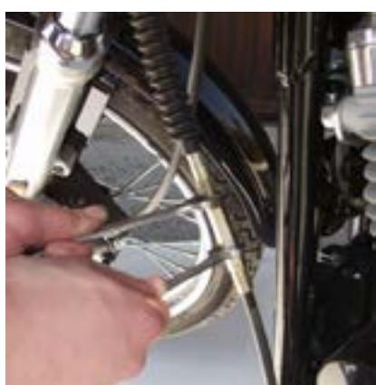
3. Afloja el tensor del cable del lado del embrague y déjalo suelto.
