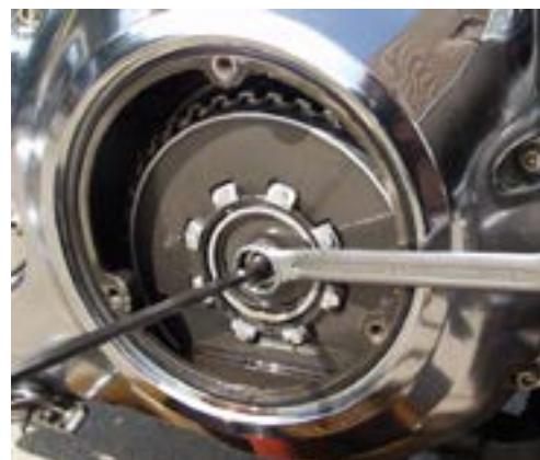
5. Togliere l'anello di sicurezza tramite pinza Seeger, separare il segmento frizione originale H-D dal cavo, togliere il segmento e trasferire le tre sfere nel segmento Müller.
