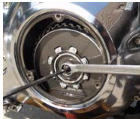
5. Sicherungsring mit Seegerringzange entfernen, orig. H-D Kupplungssegment vom Zug trennen, Segment aussondern und die drei Kugeln ins Müller Segment umrüsten.
