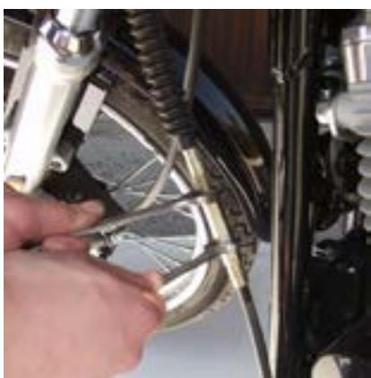
3. Schrauben für Servicedeckel mit Inbus 5/32" oder Torx TX 27 Werkzeug lösen, Kontermutter von Kupplungseinstellschraube mit 11/32" Schlüssel lösen, anschließend mit 7/32" Inbus-schlüssel Kupplungseinstellschraube lockern.
