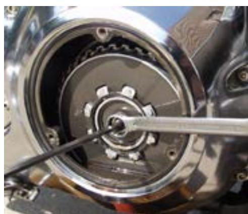
5. Retirer le clip avec une pince circlip, détacher le segment d'embrayage du câble, déposer le segment et insérer les trois billes dans le segment Müller.
