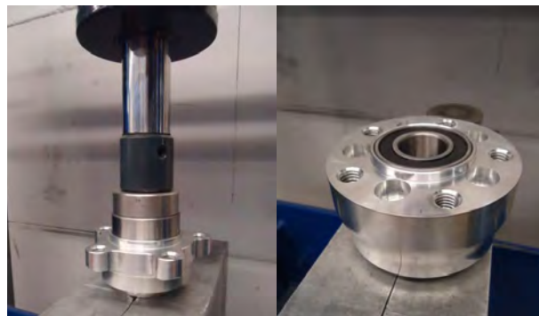
1 mitad del buje lado de la polea 7/16"
