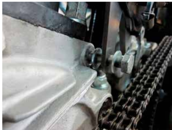
Placez des rondelles selon le besoin, pour une installation sans tension.
