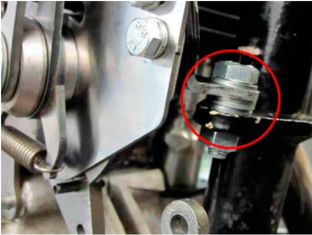
Colocación del soporte en ángulo trasero de la carraca del cambio
