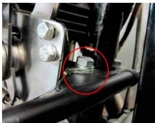
Position d'angle du support arrière
