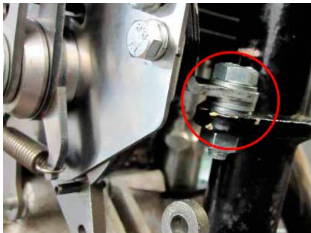
Installazione priva di portacavo frizione di serie
