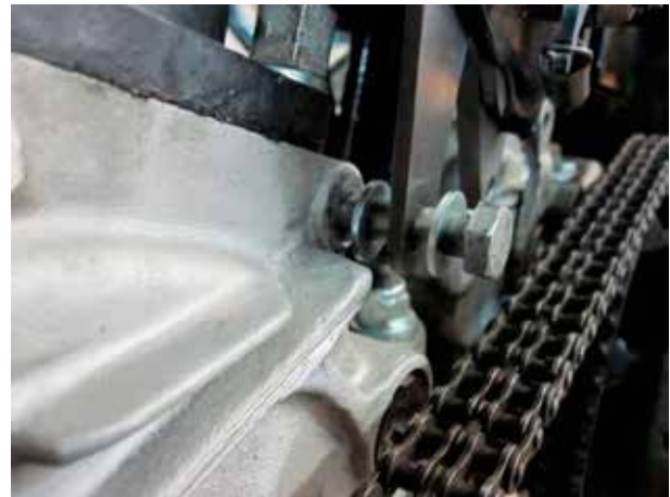
Unterlegscheiben nach Bedarf platzieren für einen spannungsfreien Anbau
