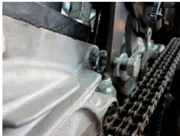
Piazzare rondelle secondo necessità per un'installazione priva di tensione
