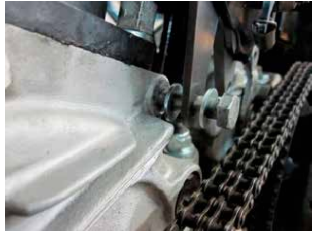
Coloque arandelas como se indica para que no haya tensión en el montaje.
