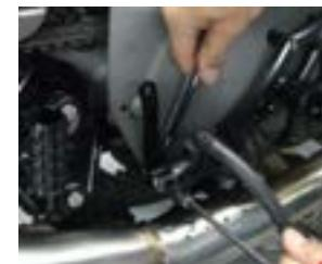
6. Ora installi il perno nuovo al cilindro maestro e fissi quest'ultimo al pedale del freno utilizzando i componenti su misura. Serri le viti a 17 - 22 ft-lbs (23 - 30 Nm).
