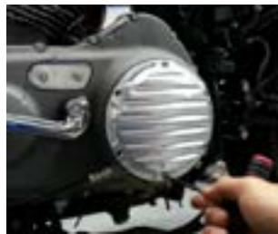
2. Montieren Sie die Grundplatte mit den mitgelieferten Haltern und Schrauben mit einem Drehmoment von 90 - 100 in-lbs (10 - 11 Nm).
