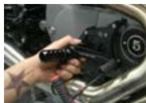
Va montato il supporto da .760" al posto di quello da .880" se si installa il coperchio puleggia RSD.
