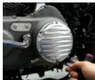
2. Monte la placa de soporte utilizando los espaciadores y tornillos que se suministran. Apriete a 90 - 100 in-lbs (10 - 11 Nm).
