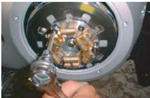
8. Die Papierdichtung in der Mitte ausscheiden (wenn vorhanden) wie im Bild gezeigt oder stattdessen den O-Ring der späteren Modelle montieren (WW 57-980).
