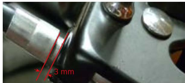
10. Mettere il coperchio frizione e stringere le viti procedendo a croce. Potrebbe rendersi necessario impiegare un anello distanziatore per il coperchio frizione (WW 80-908). La coppia con la quale vanno strette le viti del coperchio frizione è 9.5-12.2 Nm. (84-108 in.lbs). Tirare la leva frizione. Se non ci sono resistenze e la frizione risulta morbida, allora l'installazione è avvenuta con successo.
