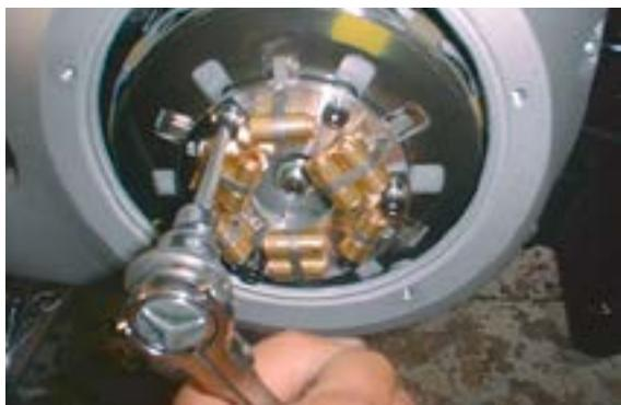
8. Découper le joint papier dans son centre (lorsqu'il est présent), comme le montre l'illustration, ou monter à sa place un joint torique des modèles plus récents (WW 57-980).
