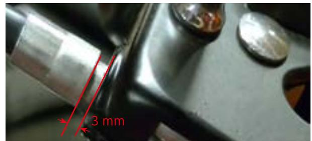
10. Den Kupplungsdeckel aufsetzen und die Schrauben kreuzweise anziehen. Es kann notwendig sein, einen Abstandsring für den Kupplungsdeckel zu verwenden (WW 80-908). Das Anzugsdrehmoment für die Kupplungsdeckelschrauben ist 9.5-12.2 Nm. (84-108 in.lbs) Den Kupplungshebel ziehen, wenn nun nichts hakt und sich die Kupplung weich ziehen lässt, ist der Einbau erfolgreich beendet.
