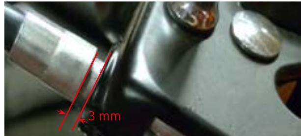
10. Coloque la tapa del embrague y apriete los tornillos en orden cruzado. A veces es necesario colocar un distanciador en la tapa del embrague (WW 80-908). Por último, apriete los tornillos en orden cruzado a un par de 9,5-12,2 Nm (84-108 pulg. libras). Suelte la maneta de embrague y, si se mueve con suavidad, es que el montaje está correcto.
