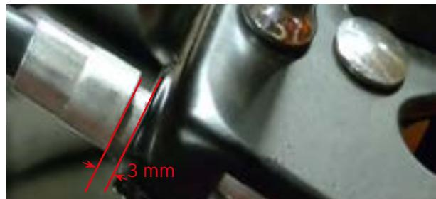
10. Installer la trappe d'embrayage et serrer les vis en croix. Il peut être nécessaire d'utiliser une bague de calage pour la trappe d'embrayage (WW 80-908). Le couple de serrage des vis de trappe d'embrayage est de 9.5-12.2 Nm. (84-108 in.lbs). Après le réglage du jeu du câble, actionner le levier. Si rien n'accroche et que l'embrayage se laisse actionner avec douceur, le montage a réussi.
