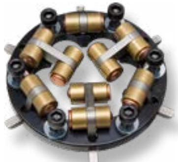
**Fliehkraftunterstützte Kupplungsdruckplatte von T.P.P.; passend für Dyna 1998-2017 und Softail 1998-2017 (außer CVO und SE Modelle 2013→), Touring 1998-2016 (außer Low 2015-2016); Big Twin 1998-2017 bis 124 cui.**
