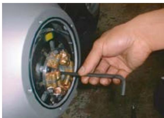
3. Allentare l'anello di tenuta della molla in modo uniforme. Per farlo, svitare man mano i bulloni 6 M6x16 della flangia usando una chiave da 10 mm. Mettere da parte l'anello di tenuta della molla e i bulloni.
