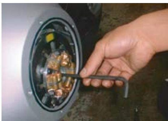
3. Dévisser de manière égale la bague de maintien des ressorts. Pour cela, desserrer progressivement à l'aide d'une clef de 10 mm les 6 vis de flange de M6x16. Réserver la bague et les vis de côté.
