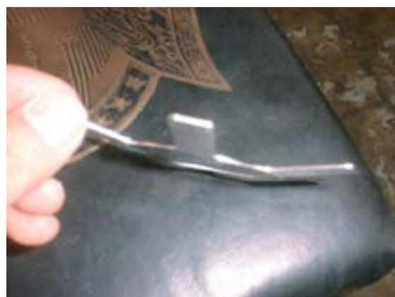
5. Empezando por la lengüeta más ancha de la placa de base, deslícela hacia dentro entre el resorte del diafragma y el plato de presión. Asegúrese de ajustarla bien hasta el final. La placa de base distribuye la presión de las manetas protegiendo el plato de presión de aluminio de cualquier daño.
