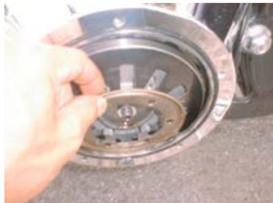
4. Die 6 Zungen der sternförmigen VP Grundplatte so biegen, dass sie vom Winkel her ungefähr dem Innern der Kupplungsdruckplatte entsprechen.
