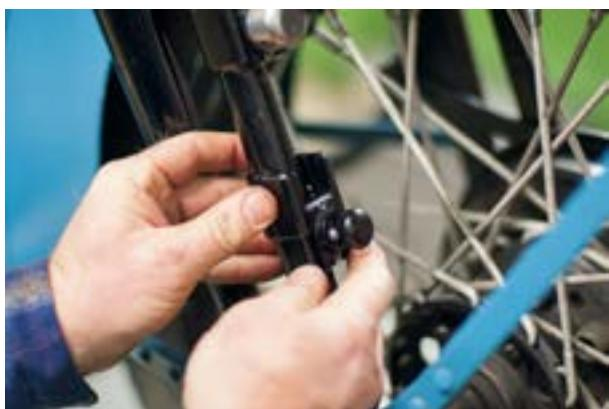
Perciò, prima del montaggio conviene oliare i pezzi e farli passare più volte dentro il morsetto, se necessario usando con la dovuta cautela un martello di gomma, fino a che tutti i componenti non scivino agevolmente.
