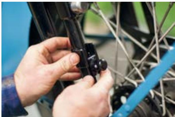
Vor der Montage ist es daher empfehlenswert, die Teile einzuhören und die Schieberstücke einige Male durch die Klemmen zu drücken, ggf. unter vorsichtiger Verwendung eines Gummihammers, bis die Komponenten leichtgängig sind.
