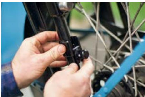
Avant d'installer ces pattes sur les bras de fourche, il est par conséquent recommandé d'huiler tous les composants et de pousser les pièces coulissantes plusieurs fois à travers les pattes, si besoin en s'aident légèrement d'un maillet, jusqu'à ce que le mouvement de tous les éléments se fasse sans efforts majeurs.
